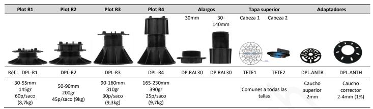
Materiales: Polipropileno reciclado – Capacidad de carga: 1,6 à 4,5 Toneladas/m² (dependiendo del número de plots por m²) – Resiste a las temperaturas: de -25 à +70°C
