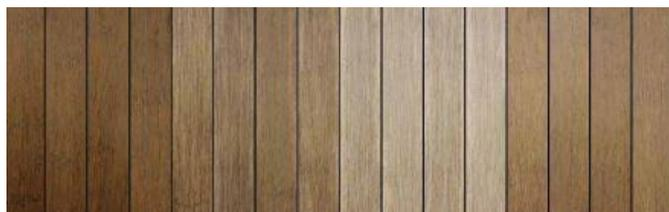
Tras instalación Un año después Después de limpieza Tras mantenimiento
