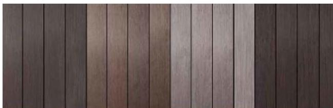
Tras instalación Un año después Después de limpieza Tras mantenimiento
